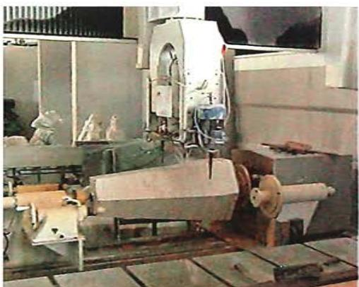
izradu pojedinog kamenog komada. Stroj poslušno izvršava naredbe i oblikuje novi kameni element. Nakon stroja novi element ide na ručnu obradu. Jedan ogradni element za drugu galeriju, koji je skinut sa stroja, ako nema nikakvih problema, treba još dva dana ručno obrađivati da
